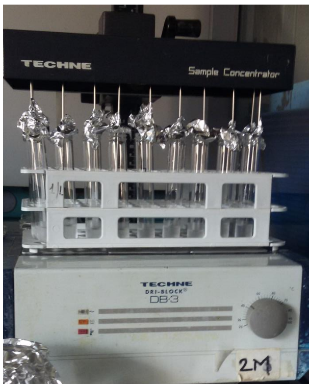
Imagen 13. Chorro de nitrógeno puro al que fueron sometidas las muestras
