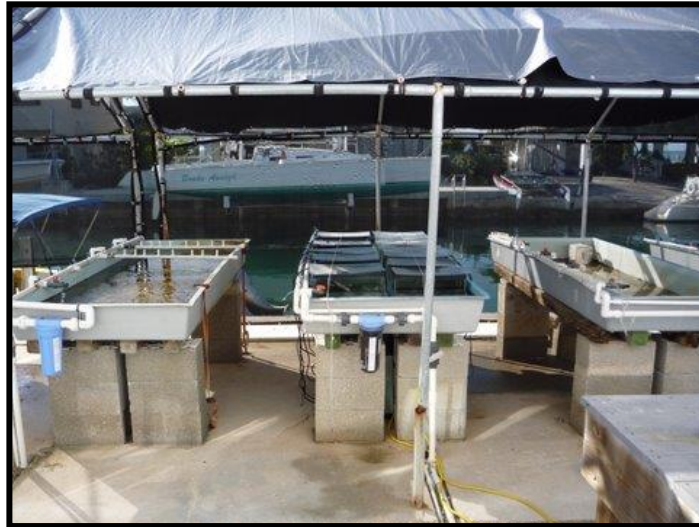
Figuras 1. Guarderías de coral ex situ con tubos de PVC, sogas, estructuras de concreto, entre otros materiales.
